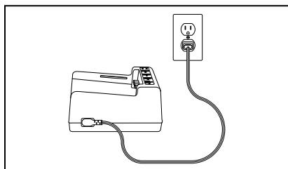
Utilice los cables suministrados únicamente con el cargador. En el primer uso, compruebe que el tipo de enchufe coincide con el receptáculo.
